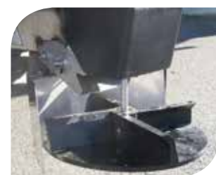
Disque d'épandage synthétique Déflecteur arrière inox
