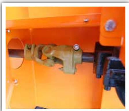
Le fonctionnement de la vis d'alimentation et du tambour est protégé en cas de surcharge par un accouplement à boulon de cisaillement, pour une sécurité élevée.
