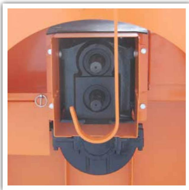
Transmission HD ultrapuissante pour montage avant et arrière (1000 tr/min arbre d'entraînement supérieur / 540 tr/min arbre d'entraînement inférieur).
