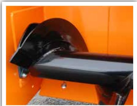
Tous les modèles H et HD sont équipés en série d'une tôle de renforcement.
