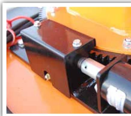
Toutes les fraises à neige Optimal possède un engrenage à vis sans fin. Cette caractéristique unique permet l'auto-nettoyage de la fraise à neige et maintient le conduit d'éjection verrouillé dans la position souhaitée. L'illustration montre également le raccord de graissage.
