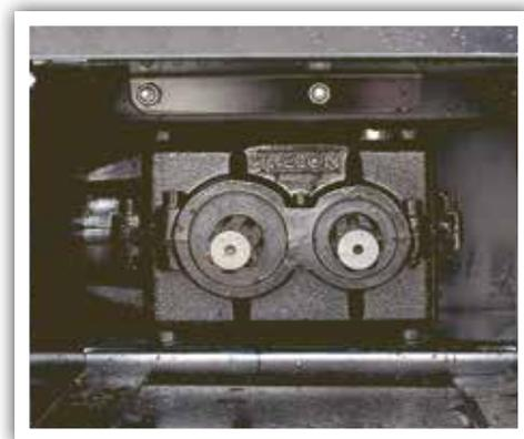
Transmission puissante avec double prise de force 540/1000 tr/min ou 540/2000 tr/min et inverseur de rotation intégré.
