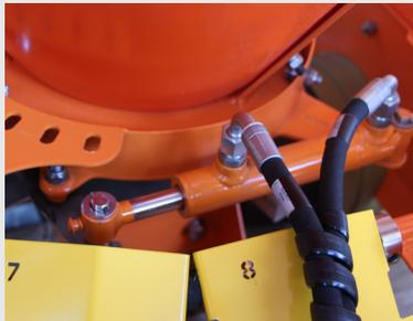
Ouverture et fermeture de la trappe hydraulique
