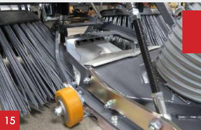
La distance entre le sol et la bouche d'aspiration doit être comprise entre 1 à 2 mm.
