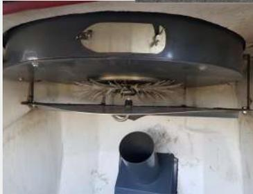
La turbine d'aspiration est fixée sur le haut du conteneur et dispose d'une brosse rotative avec buse d'eau pour empêcher la poussière en sortie de turbine.
