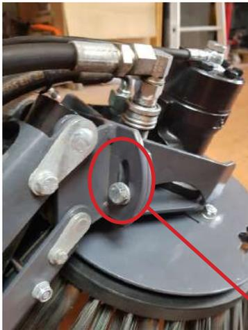
Ce réglage permet d'adapter correctement la position de la brosse à la configuration du caniveau (les anciens caniveaux sont souvent plus bas que la route et inclinés) et donc d'assurer un bon nettoyage tout en préservant les brosses et la structure du bras.
