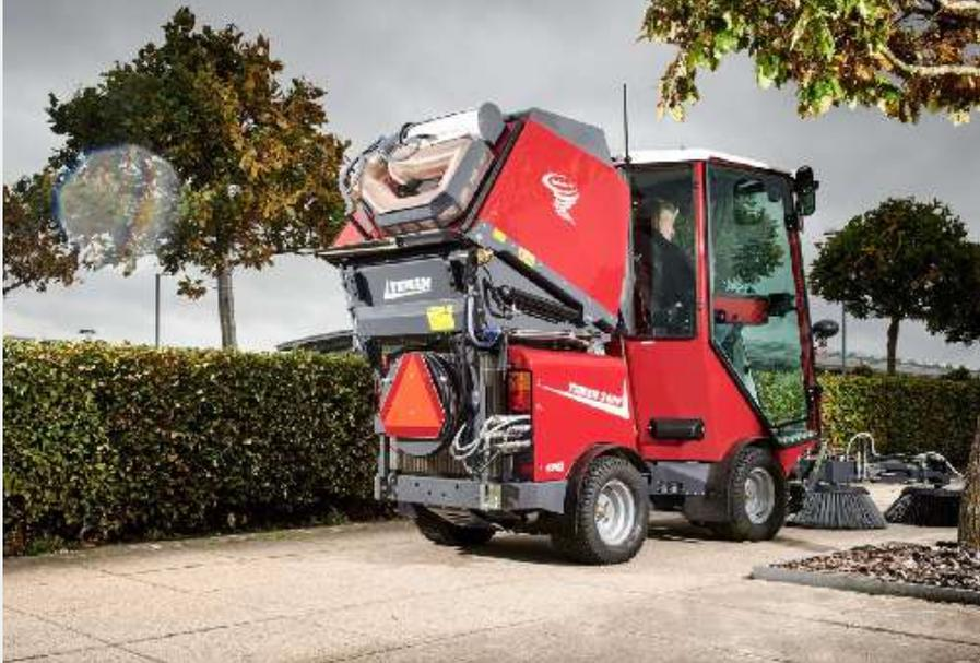
Le conteneur est équipé de 2 vérins lui permettant de basculer, tout en garantissant stabilité et durée de vie du conteneur. Hauteur de basculement de 1350 mm. Le conteneur est équipé de série d'un tuyau de 7 m pour aspiration manuelle. Le tuyau étant fixé sur la partie arrière du conteneur sa mise en œuvre est aisée.
