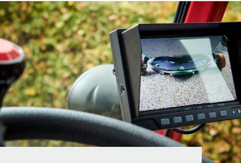
Surveillance du résultat du balayage grâce à la position à droite de la caméra de buse d'aspiration.
