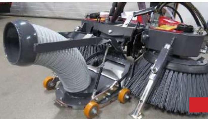
Les quatre roues permettent d'assurer la distance au sol constante.
