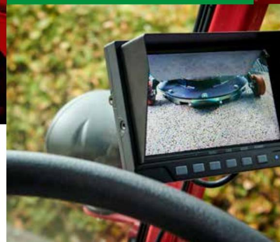
Vous n'êtes plus obligé de sortir de la cabine et de contrôler si tout marche bien. La caméra de la buse d'aspiration peut être combinée à une caméra proposant la vue arrière avec commutation automatique, pour une vision optimale.
