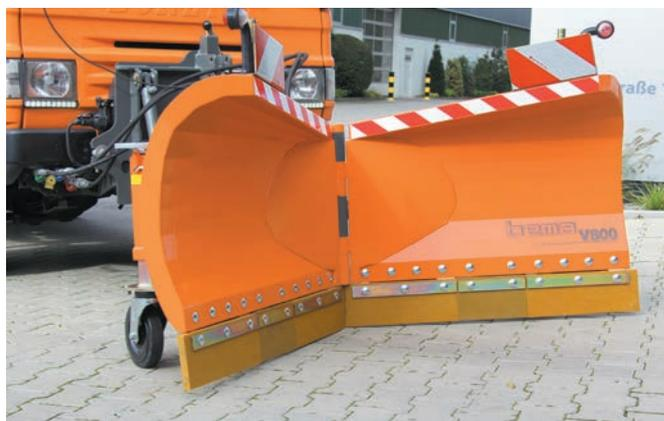
Lame à neige en V bema V800 en position Y sur un véhicule communal
