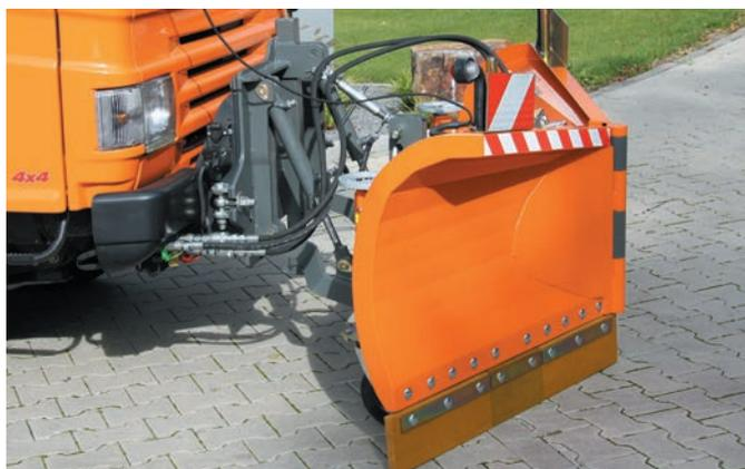
Lame à neige en V bema V800 en position V sur un véhicule communal
