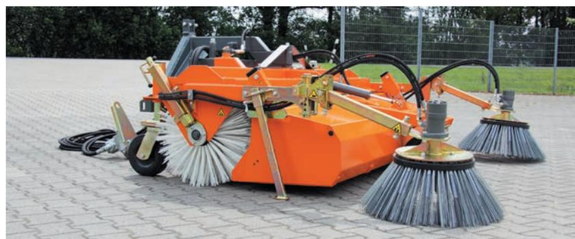
bema 25 Dual équipé de deux balais latéraux – garniture de désherbage (de série avec bema SideControl)
