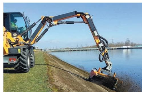
bema 25 avec brosse de désherbage, montée sur pelleteuse (construction spécifique)
