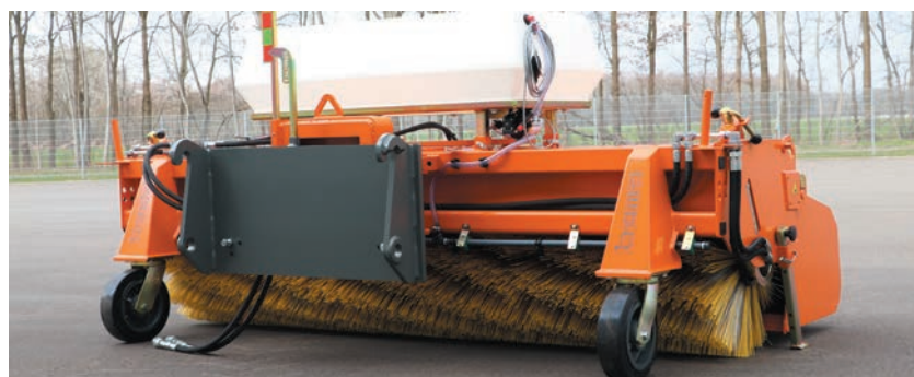
Plaque de montage rapide avec système d'équilibrage par roulettes et bema-mètre
