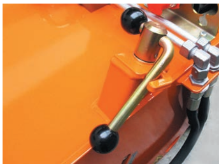
Réglage continu de la pression d'appui
