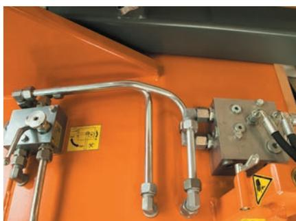
bema SideControl et bloc de commande hydraulique
