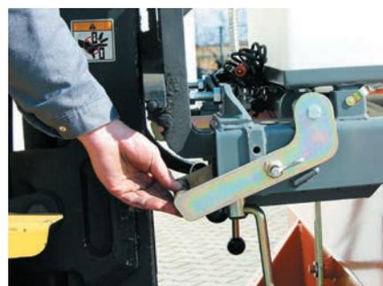
Verrouillage du logement sur chariot élévateur
