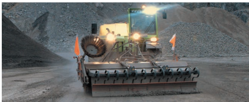
bema 75 Dual PowerMaster équipé du dispositif de racleur et de l'installation de lavage haute pression de bema
