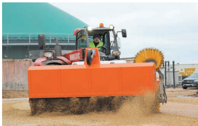
Balayage libre moyennant la bema 75 Dual PowerMaster sur une installation de biogaz
