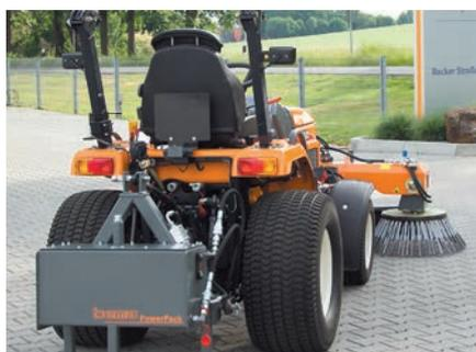
bema PowerPack - unité d'entraînement hydraulique
