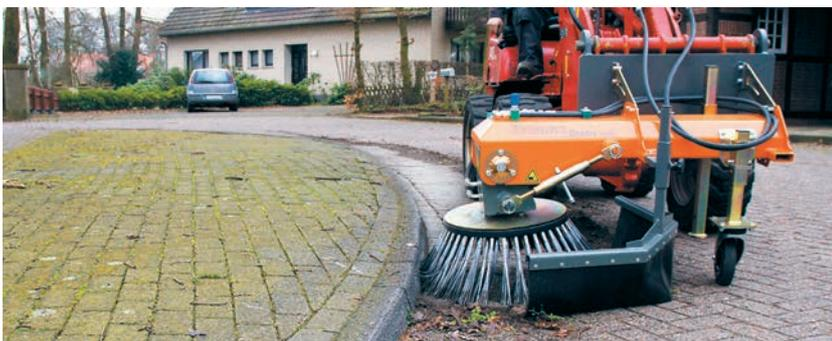
bema Groby light, montage sur mini-chargeuse (dispositif de montage rapide)
