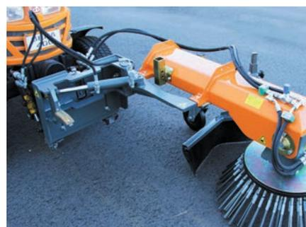
Système d'inclinaison hydraulique
