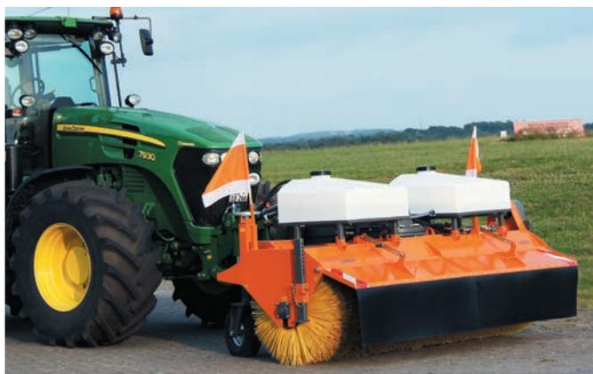
bema Jumbo montée sur le tracteur (attelage frontal)
