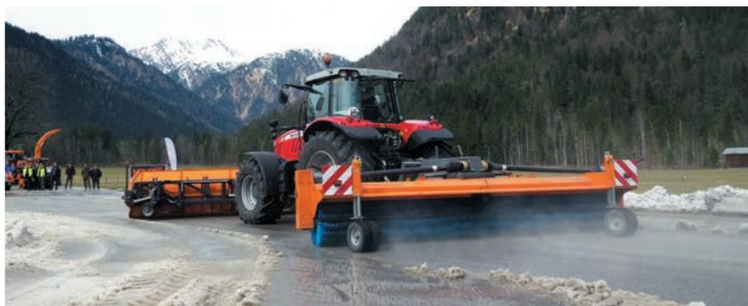
La bema Jumbo Airport Turbo se singularise par sa largeur de travail de 5 200 mm.
