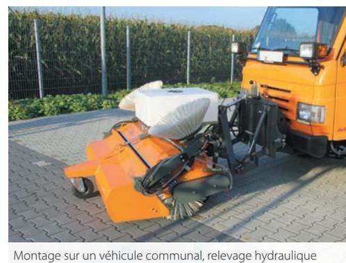
Montage sur un véhicule communal, relevage hydraulique
