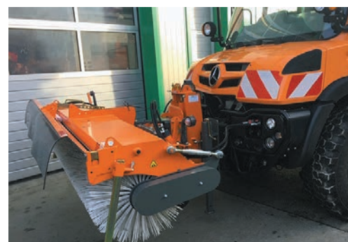
Attelage à l'Unimog, relevage hydraulique
