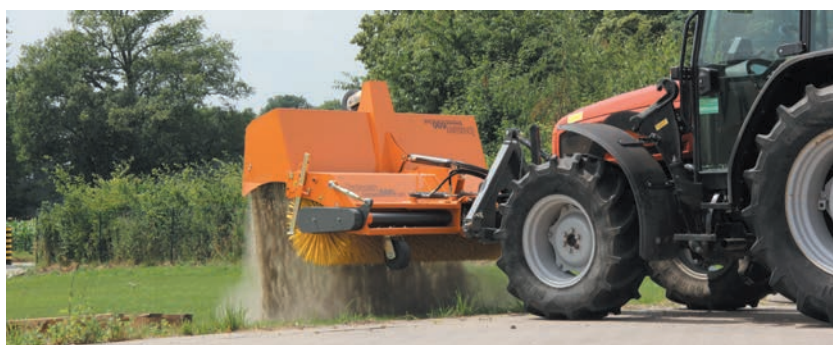
Vidage hydraulique du bac de ramassage
