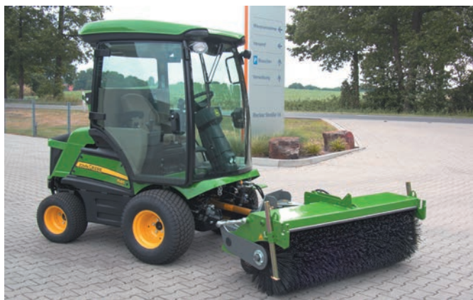
bema Kommunal 600 Dual sur tondeuse frontale (attelage spécifique)
