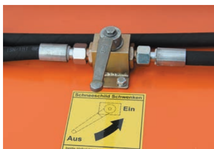
Robinet d'arrêt pour le blocage de la lame de déneigement à l'état relevé
