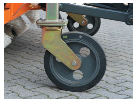
Roues porteuses robustes – réglage par manivelle
