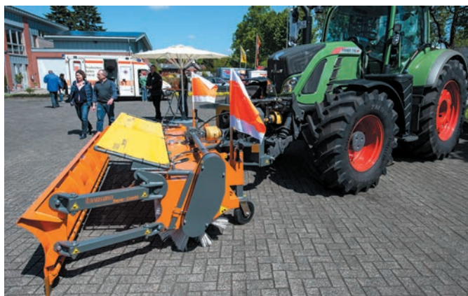
bema Snow-Combi sur tracteur et avec protection contre la poudreuse en option
