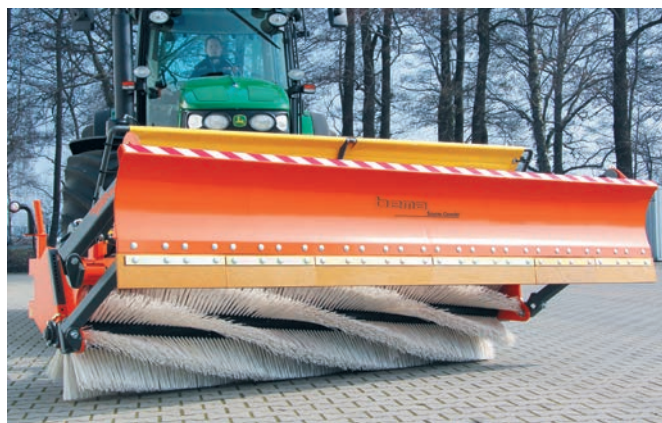
bema Snow-Combi avec lame de déneigement à l'état relevé – balayage libre
