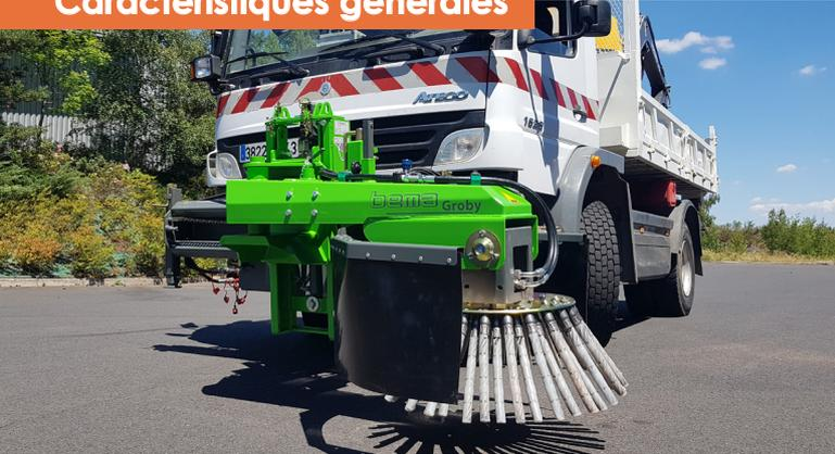
La désherbeuse BEMA GROBY est conçue pour être installée sur des plaques avant de camions ou tracteurs agricoles, ainsi que sur des relevages avant.
