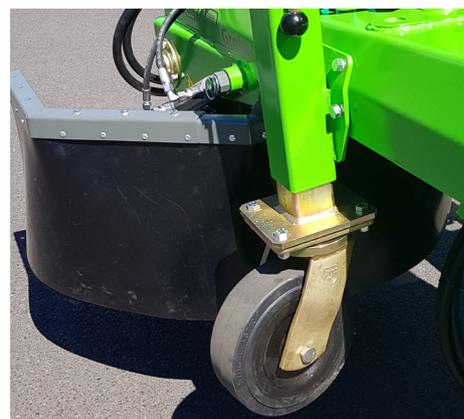
Roue de jauge 250 x 80 mm avec réglage en continu de la profondeur
