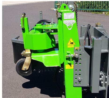
Réglage de la hauteur et de l'inclinaison de la machine
