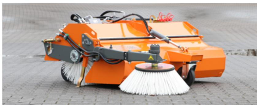
bema Kommunal 580 Dual avec système d'inclinaison hydraulique et brosse latérale
