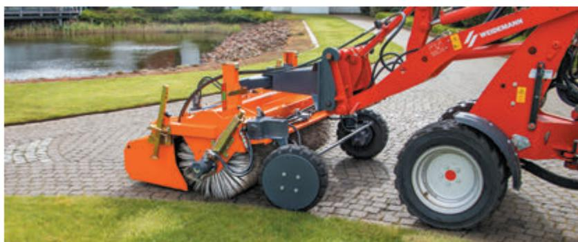
Dotée de deux entraînement de roues orientables, la balayeuse est indépendante du véhicule porteur
