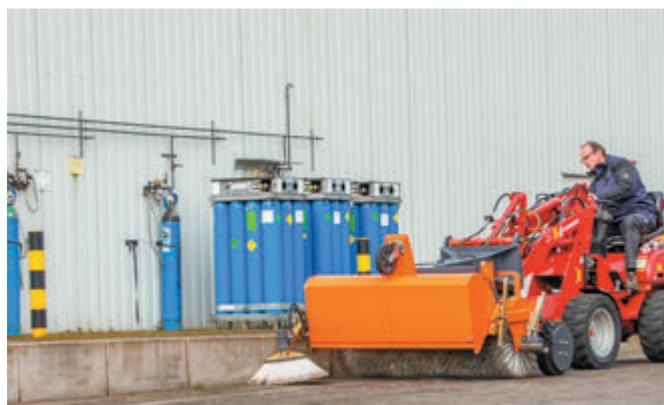
Bac de ramassage dans le système Dual éprouvé, par ex. balayage libre avec bac de ramassage ouvert
