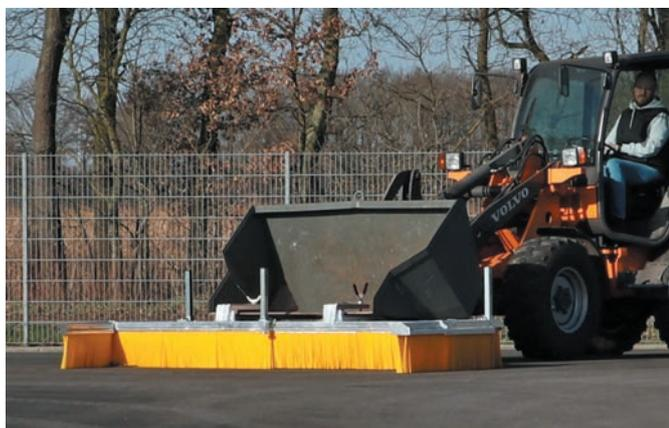
bema 11 MultiClean avec logement pour godet y compris vis de serrage
