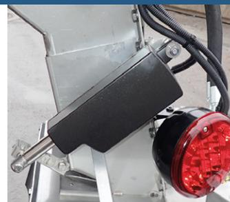
Coffre de protection des éléments hydrauliques
