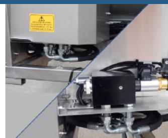
Boîtier de connexion électrique IP65, 12 ou 24V
